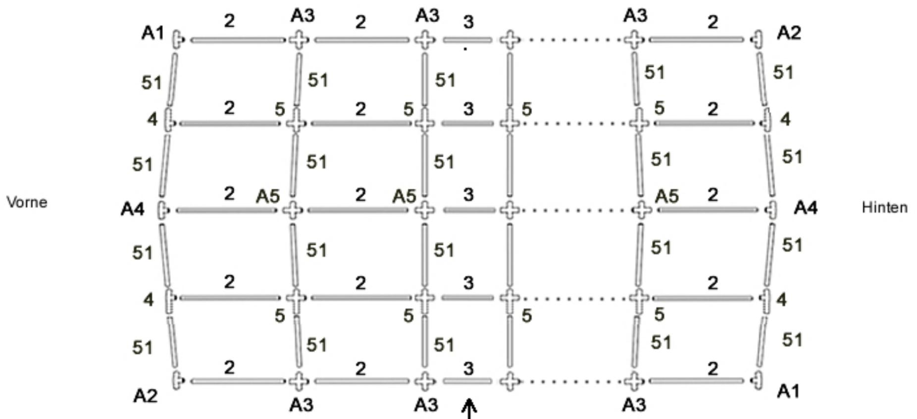
Das Verlängerungsrohr des Zeltes (1m) soll in der dritten Sektion platziert werden.
