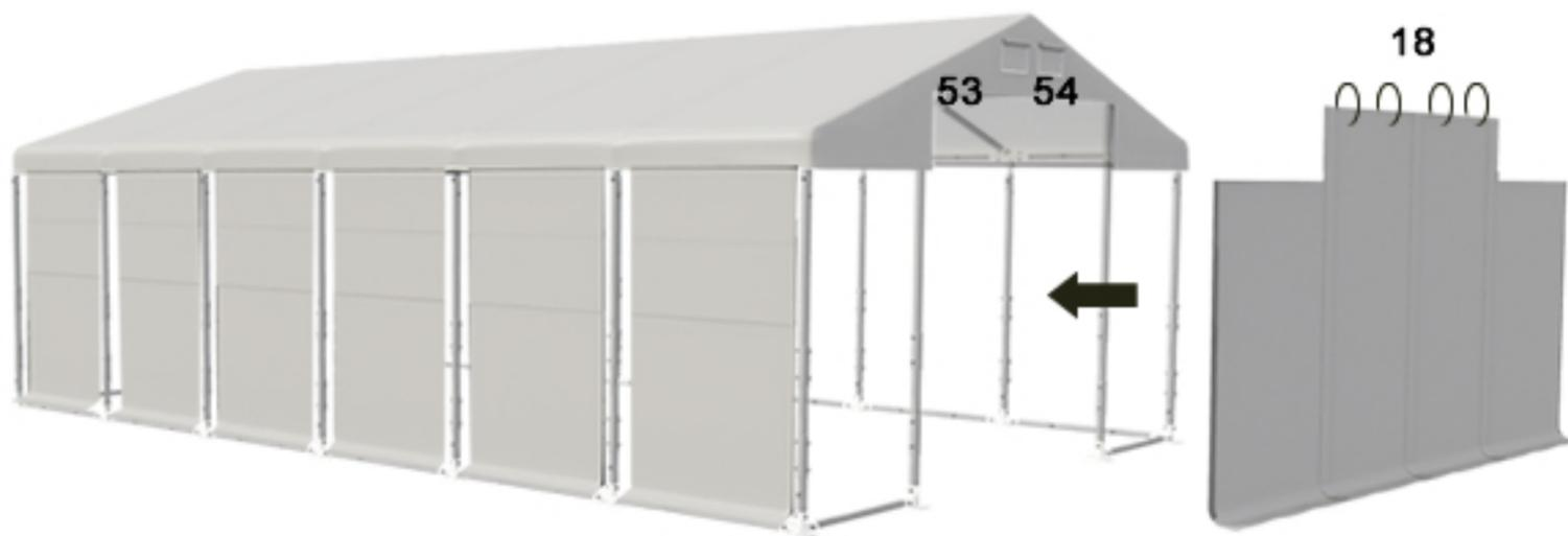
Die Eingänge auf beiden Seiten des Zeltes mit Gummischlaufen befestigen. Den oberen Teil des Eingangs mit Stahlringen (Nr. 18) an dem horizontalen Rohr anbringen (zusammengestellt aus den Rohren 53 und 54)
