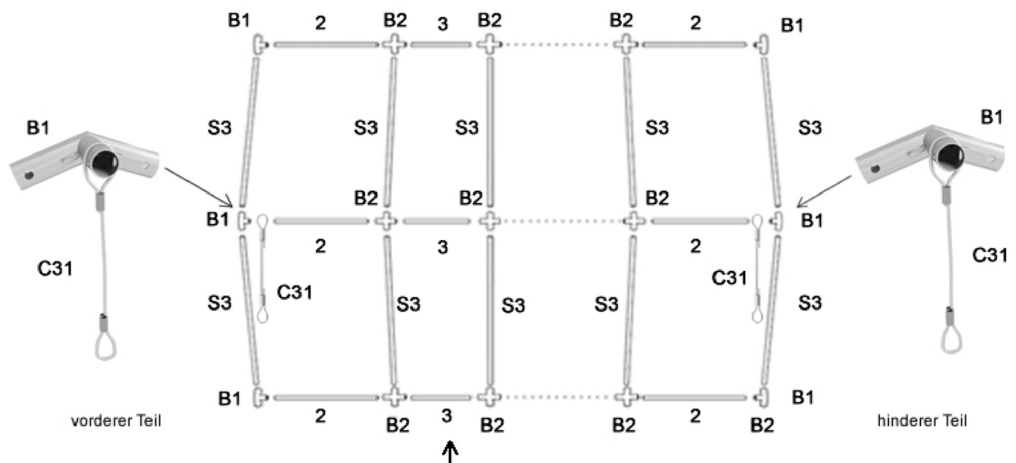
Das Verlängerungsrohr des Zeltes (1m - Nr. 3) soll in der zweiten Sektion platziert werden.
