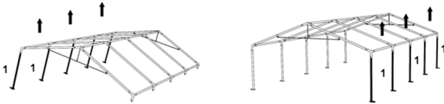
Die Seitenwändeplane mit Hilfe von Gummischlaufen direkt an der Konstruktion anbringen. Oben mit Klettverschlüssen an der Dachplane befestigen.
