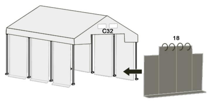
Den oberen Eingangsteil mit Stahlringen (Nr. 18) an dem horizontalen Rohr (Nr. C32) anbringen. Die Eingangsseiten mit Gummischlaufen befestigen.
