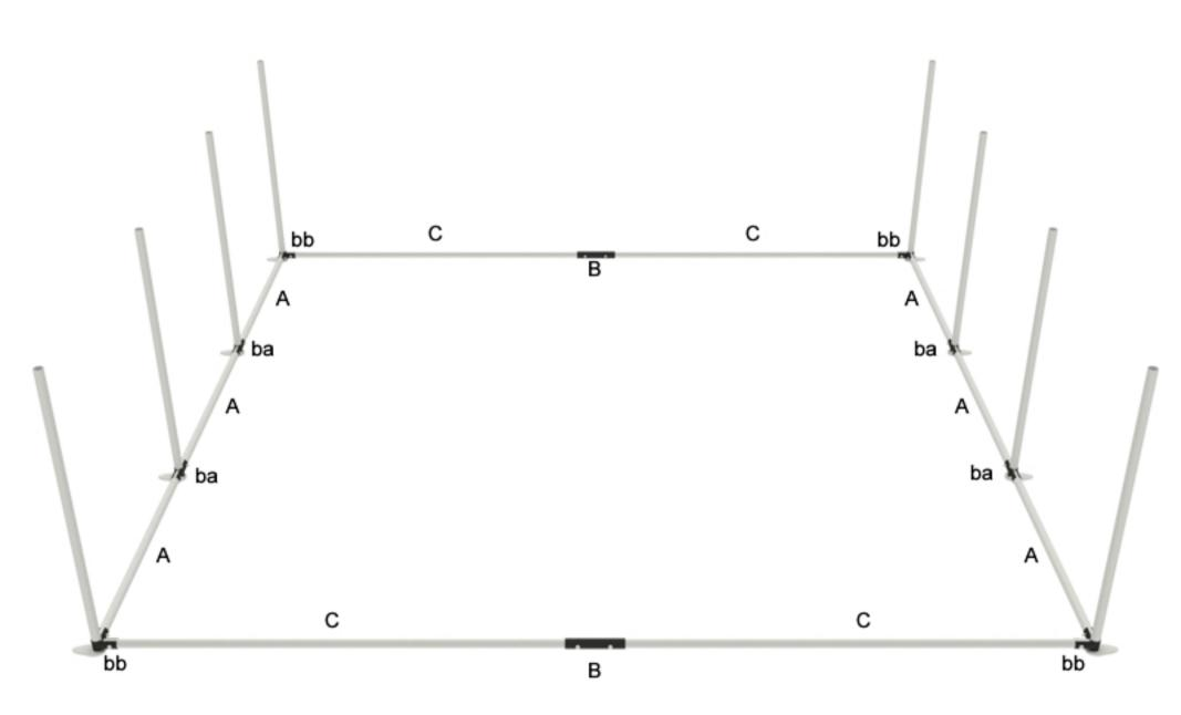
Die Bodenkonstruktion soll man mit Hilfe von den Schrauben S. wie unten auf dem Bild montieren.
