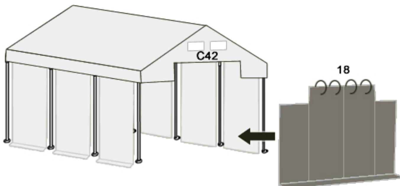
Den oberen Eingangsteil mit Stahlringen (Nr. 18) an dem horizontalen Rohr (Nr. C42) anbringen. Die Eingangsseiten mit Gummischlaufen befestigen.
