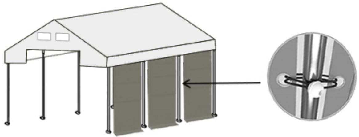
Den oberen Teil des Eingangs mit Stahlringen (Nr. 18) an dem horizontalen Rohr (Nr. 41 und 42) anbringen. Die Einfahrtsseiten mit Gummischlaufen befestigen.
