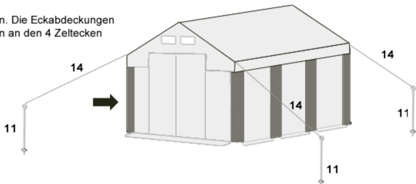
Die Dachspannseile an den Dachecken mit Hilfe von Elementen (Nr.14 u. Nr.11) montieren. Die Dachspannseile sollen gespannt befestigt werden.
