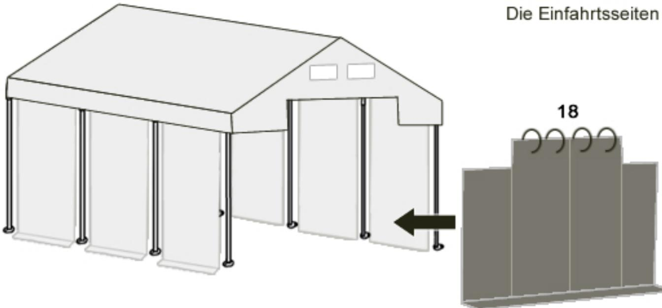
Alle Abdeckungen am Zelt montieren. Die Eckabdeckungen haben eine längere Breite und sollen an den 4 Zeltecken angebracht werden.
