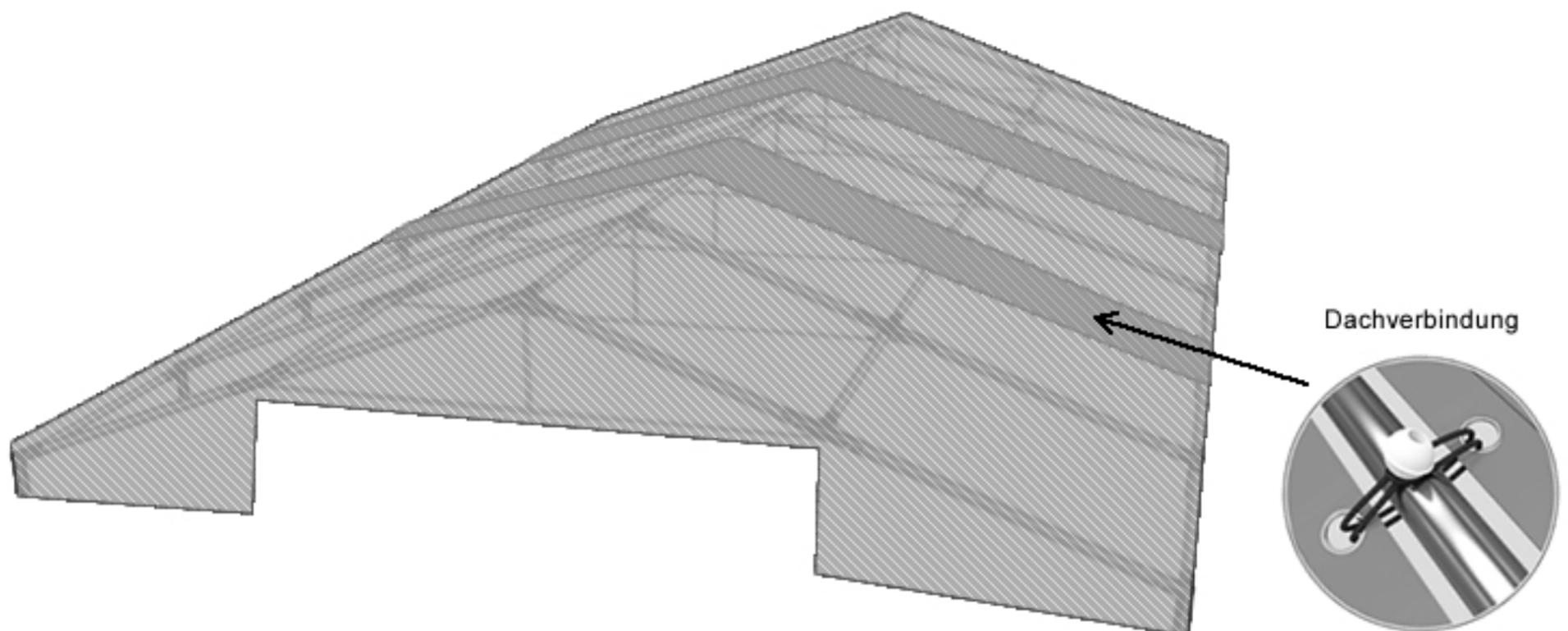
Die Rohre, die zur Planenbefestigung dienen, von der Innenseite des Zelt montieren.
