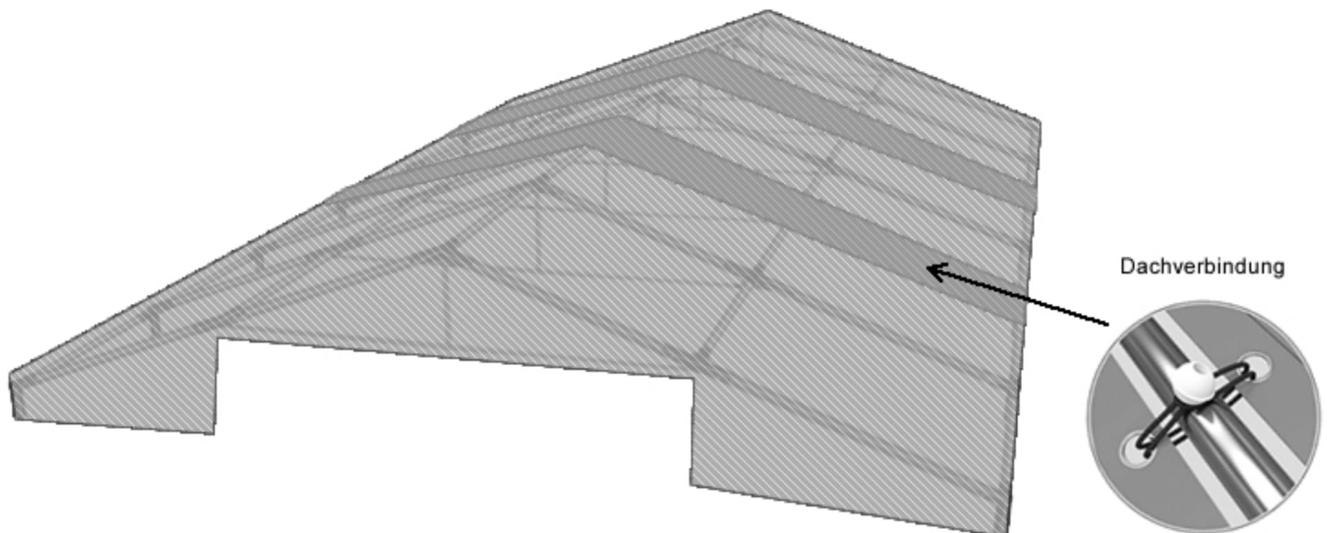
Die Rohre, die zur Planenbefestigung dienen, von der Innenseite des Zeltes montieren.
