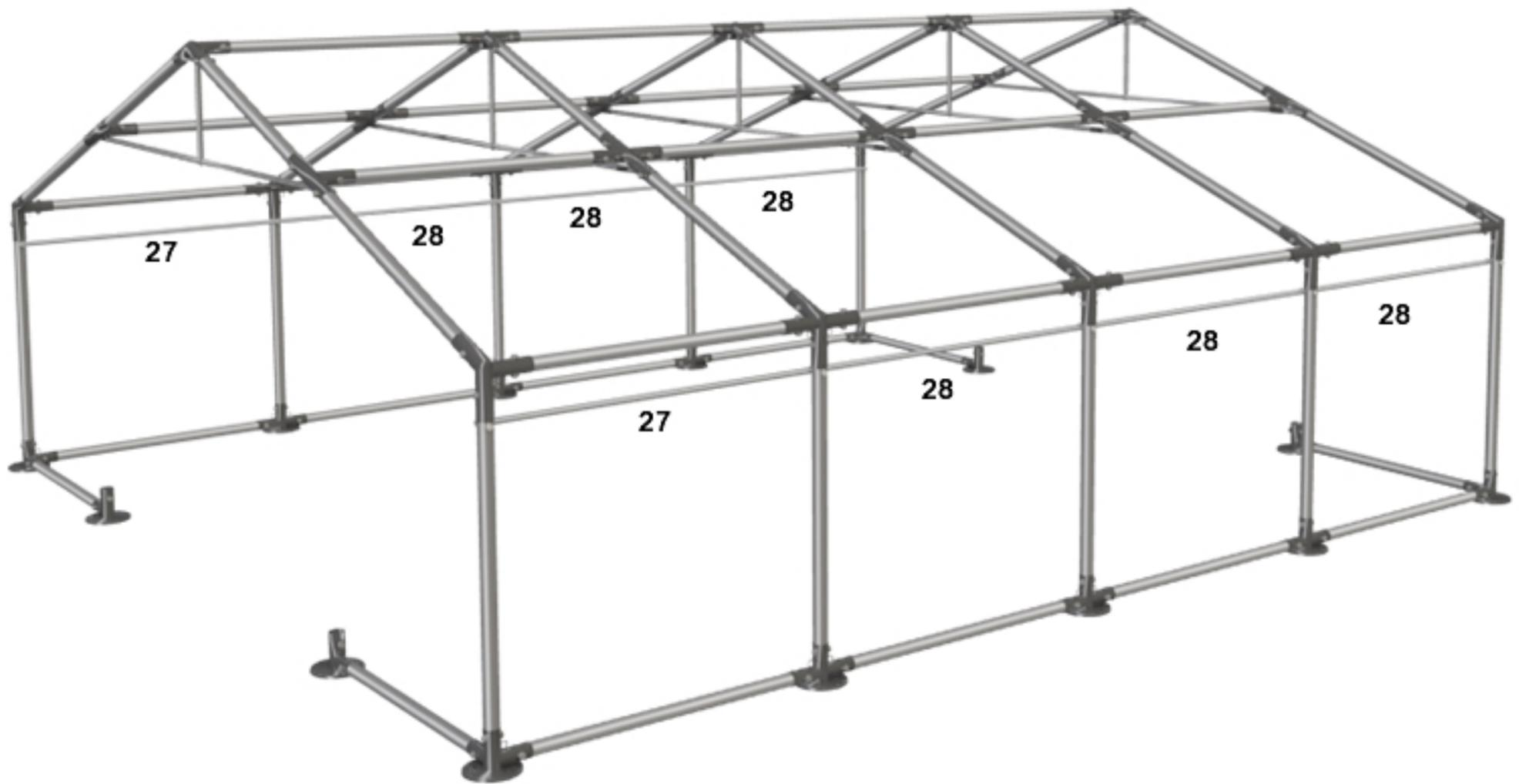
Lege das Rohr (Nr. 30) durch die Plane um. Dann verbinde das Rohr (Nr.30) mit dem Rohr (Nr.27) mit Hilfe von Klettbändern. Für Zelte mit 1m Verlängerung verwende statt des Rohres (Nr.28) das Rohr 29. Und statt des Rohres 30 das Rohr 31.
